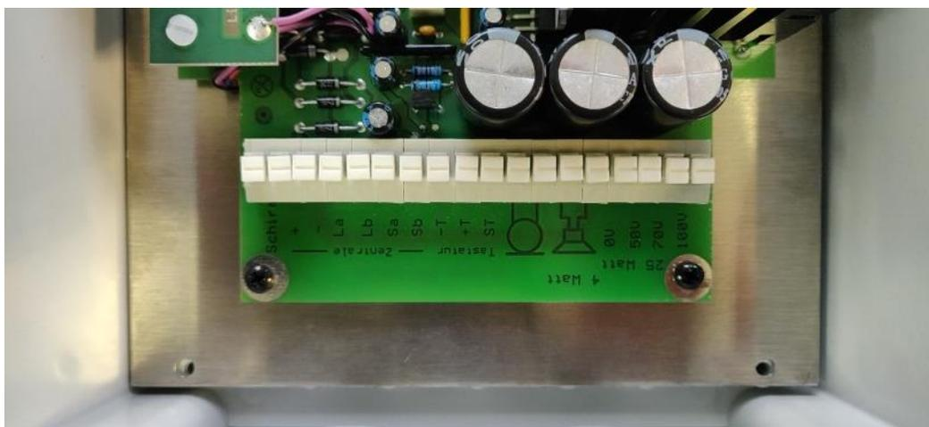
Die WAD-DrWL-Anschlussdosen werden über Standard-Fernmeldeinnenraumkabel z.B. I-Y(St)Y 4x2x0,6 an die entsprechenden Anschlüsse der PMS-02-DrWL angeschlossen. Der Anschluss der Einsprechstellen erfolgt über Standard-DTA-Anschlusskabel an die WAD-DrWL.
